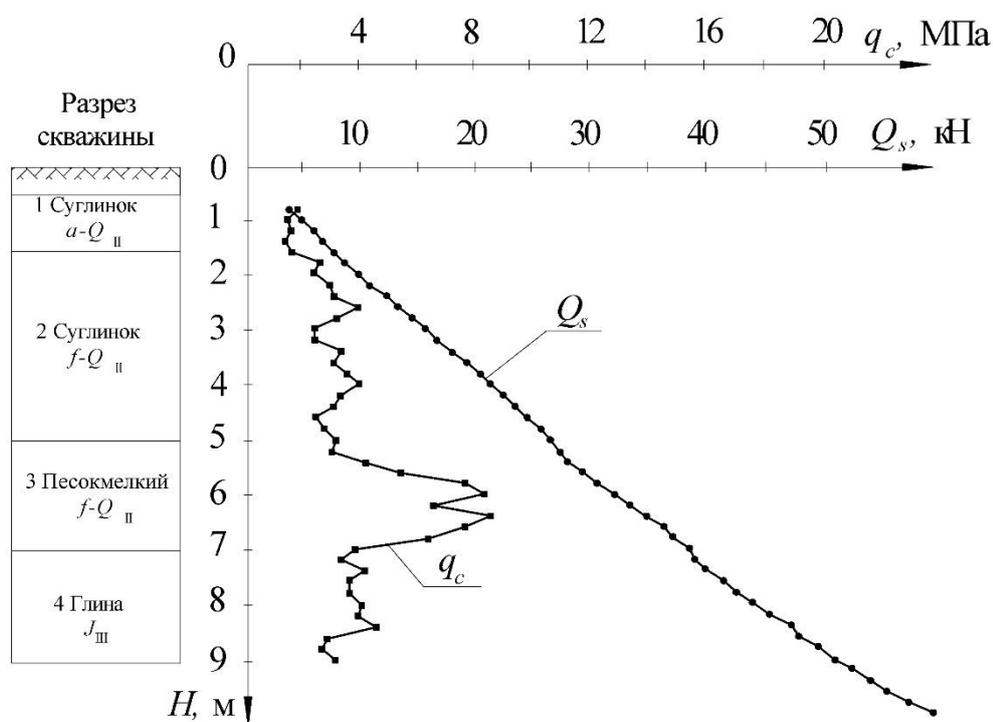
Рисунок В.1 - Графики изменения  $q_c$  и  $Q_s$  в зависимости от глубины погружения зонда  $H$
