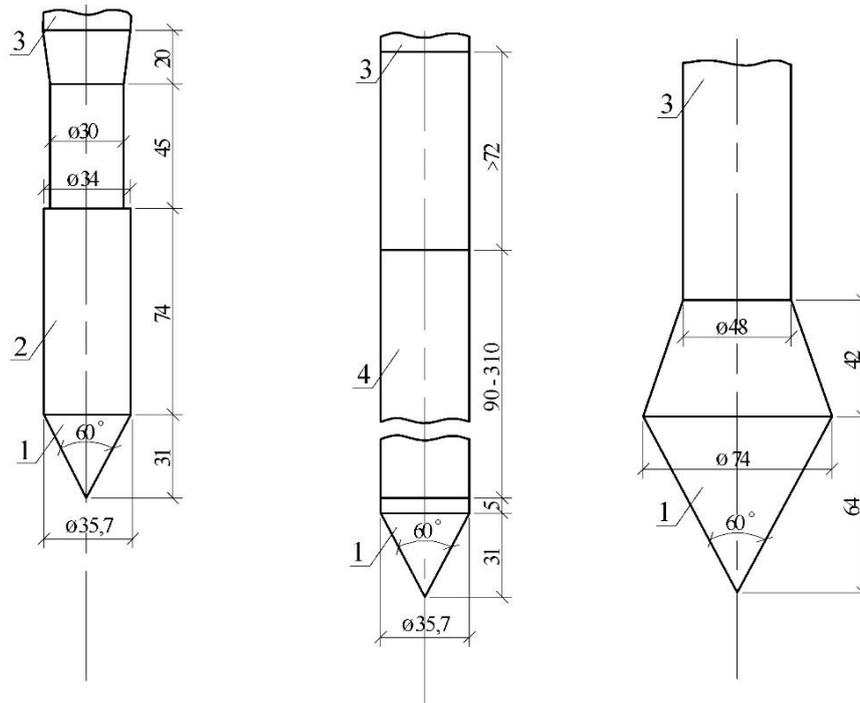
а) Механический зонд (тип I) для статического зондирования
