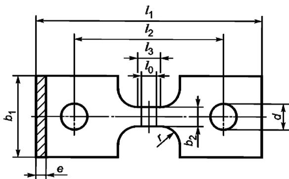
Рисунок 1 — Образец типа 3
